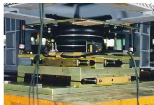
3次元免震装置
